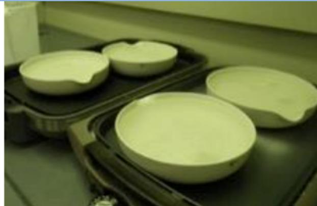
写真3-2-2-3 ドラフトチャンバー内のホットプレート上で蒸発濃縮する
