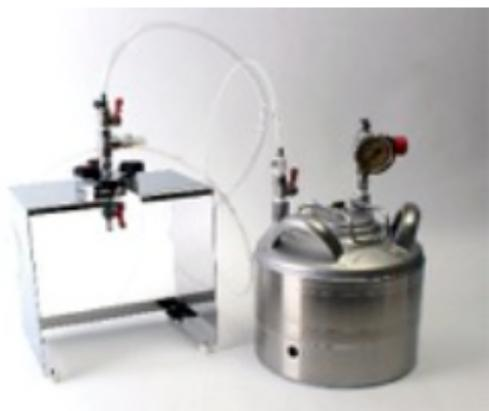
写真 3-5-3-1 加圧通水装置
