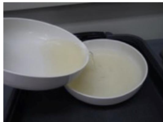
写真3-2-2-5 試料液量が少なくなったら、一つの蒸発皿に試料液を集める
