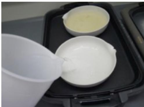
写真3-2-2-2-6 空になった蒸発皿に超純水を入れて加熱し、洗浄ビンの超純水とヘラで内壁を十分に良くこすり、付着物の取り残しができるだけ無いようにする
