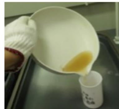
写真3-2-2-2-7 さらに少なくなった試料液をすべてテフロンビーカーに集める
