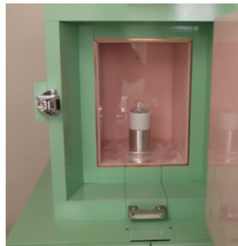
2Lマリネリでの測定：43200秒（12時間）で定量下限：0.1Bq/L程度のゲルマニウム半導体検出器を用いた場合、
