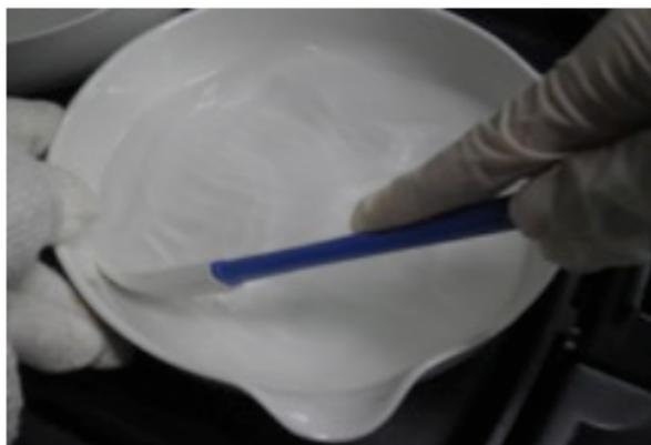
写真3-2-2-4 内壁を試料液で濡らしながらヘラで良くこすり、付着物を試料液中に入れる
