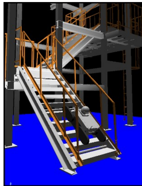
階段昇降のシミュレーション
