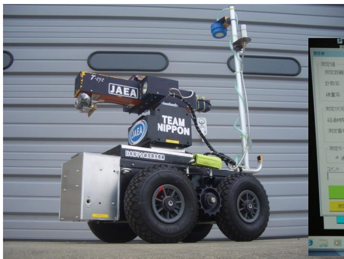
ガンマ線可視化計測装置を搭載したJAEA-3
