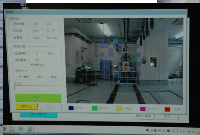
ガンマ線可視化画像(校正室内)
